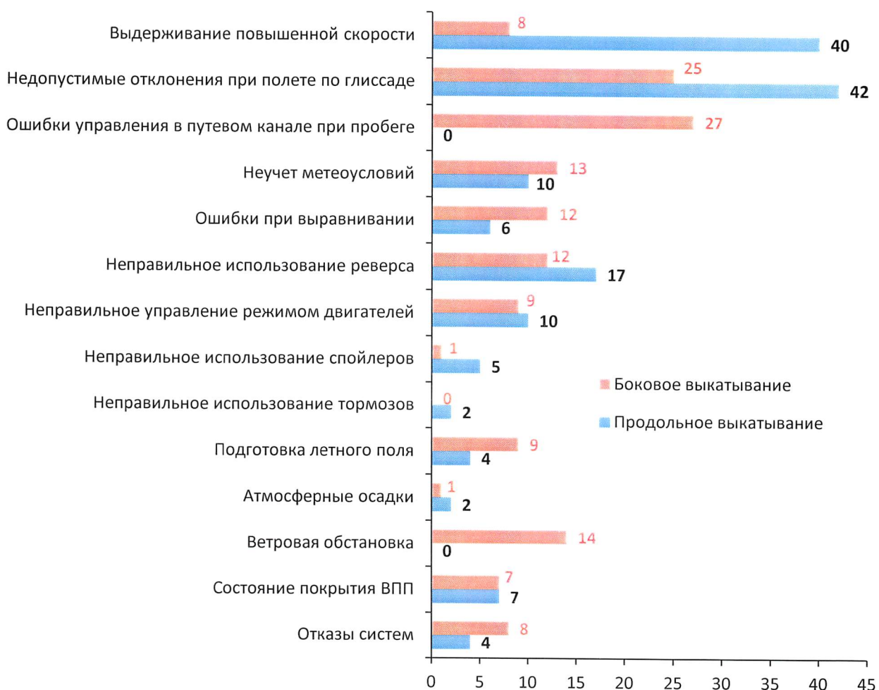
Рис. 1. Основные причины авиационных событий, связанных с выкатываниями за пределы ВПП (самолеты с максимальной взлетной массой более 2250 кг, период 2002 – 2013 годы)
